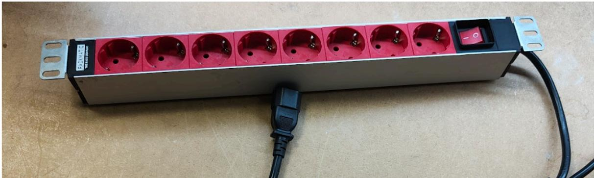
Um filtro de linha é um dispositivo elétrico que protege equipamentos contra surtos de energia e ruídos na linha elétrica. Ele filtra interferências eletromagnéticas e suprime picos de tensão, garantindo uma alimentação estável para o RACK.
