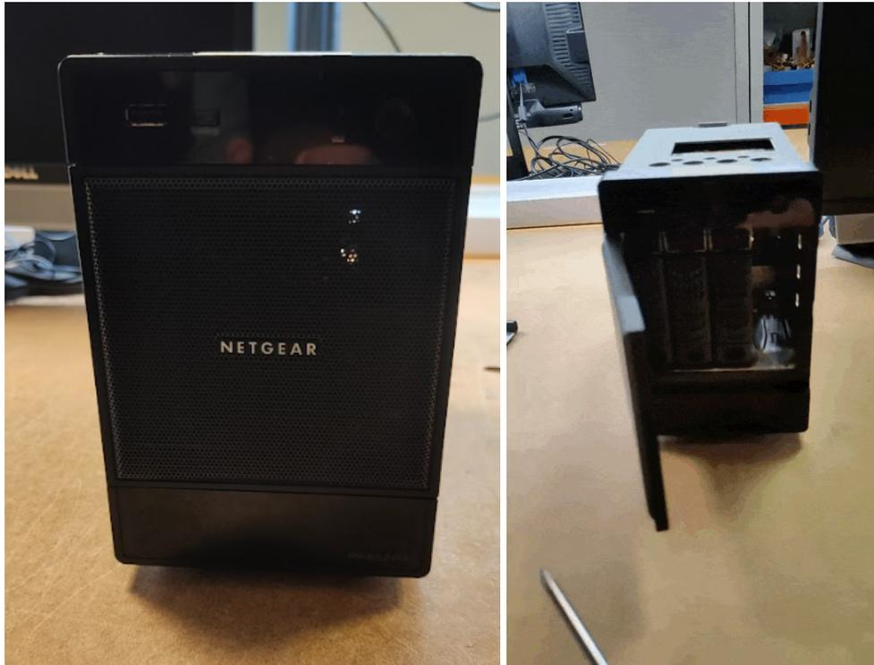
O Netgear ReadyNAS Pro 4 é um servidor NAS, é dizer, um servidor de armazenamento de dados de computador em nível de arquivo (em oposição ao armazenamento em nível de bloco) conectado a uma rede de computadores que fornece acesso a dados a um grupo heterogêneo de clientes. Este NAS tem 4 baías para até 12 TB de armazenamento e permite fazer RAID0, RAID1, RAID5, RAID6 e RAID10. Tem 1 Gb de memória principal e umas dimensões de 13,12 x 11,5 x 9,25 polegadas.
